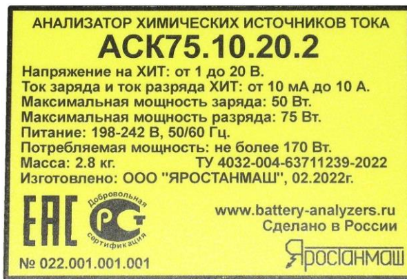
Рисунок 3 - Наклейка с серийным номером Анализатора АСК75.10.20.2 (расположена на нижней панели прибора)
