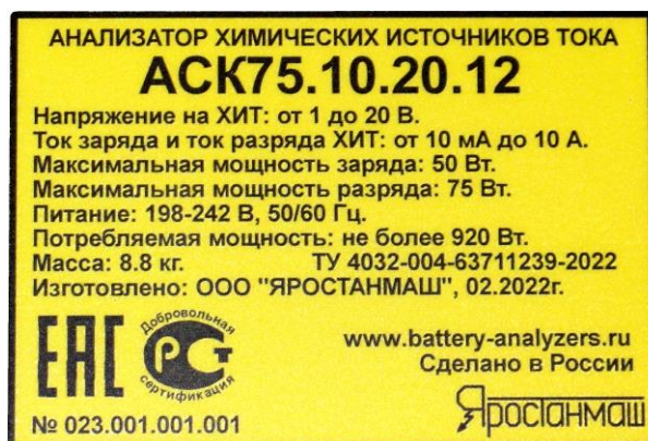
Рисунок 6 - Наклейка с серийным номером Анализатора АСК75.10.20.12 (расположена на нижней панели прибора)
